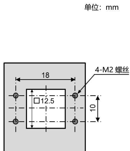
图 2. 放湿口·安装孔加工尺寸
