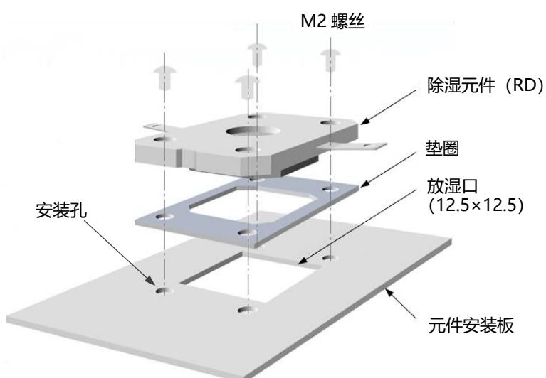
图 1. 安装示意图
