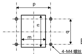
图 4. 放湿口·安装孔加工图
