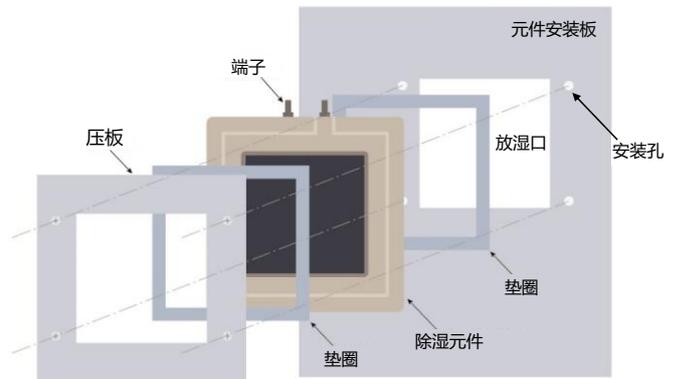
图 1. 安装示意图
